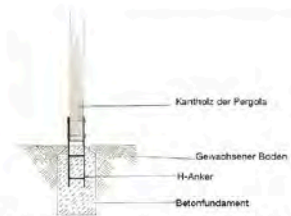
Die Pfosten der Pergola werden durch H-Anker mit Betonfundament im Boden befestigt.
